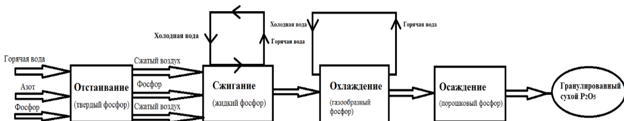
Рисунок 1.3 – Этапы получения сухого P_2O_5
